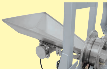
Canale vibrante sul tubo rotante per una comoda carica del materiale
