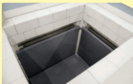
Rivestimento dei lati e del fondo con protezione in lastre in carburo di silicio per forno a pozzo S 73/HS
