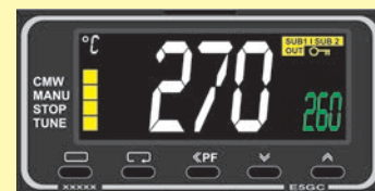
Esempio di limitatore di sovra temperatura
