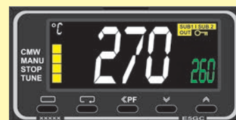
Esempio di limitatore di sovra temperatura
