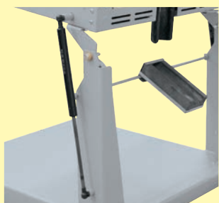
Ausilio di ribaltamento con ammortizzatori
