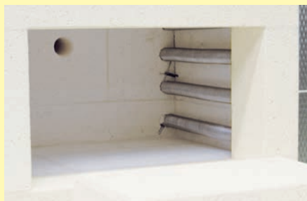
Vano forno con isolamento resistente in mattoni refrattari leggeri
