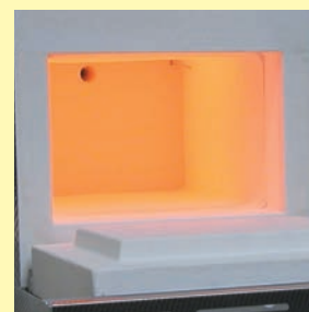
Riscaldamento della muffola da 4 lati
