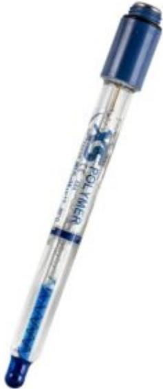
Elettrodo di pH combinato, per usi generali. Per una risposta veloce con elevata precisione in campioni che possono contaminare i normali diaframmi. Riempimento a polimero senza setto poroso. Esenti da manutenzione. Testa a vite S7, senza cavo. .
