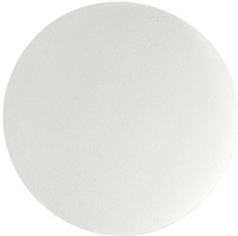
Caratteristiche principali: Usata in tecniche analitiche qualitative. Prodotta in modo da ottenere un contenuto di cellulosa minimo del 98% . E' una carta da filtro densa per la raccolta di particelle molto piccole e per la rimozione di precipitati fini. Viene usata nella preparazione di campioni, es. nell'industria delle bevande, per la determinazione dello zucchero residuo, spettri degli acidi, analisi rifrattometriche e HPLC. Disponibile anche in dischi pieghettati. .
