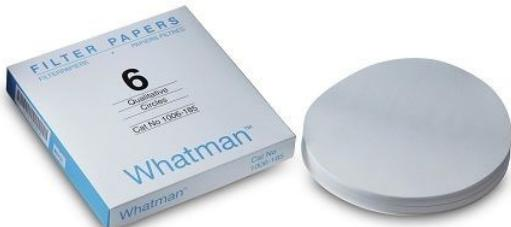
**Caratteristiche principali:** Usata in tecniche analitiche qualitative. Prodotta in modo da ottenere un contenuto di cellulosa minimo del 98% . E' due volte più veloce di quella grado 5, con un grado di ritenzione del particolato simile. Spesso viene indicata per l'analisi dell'acqua delle caldaie. .
