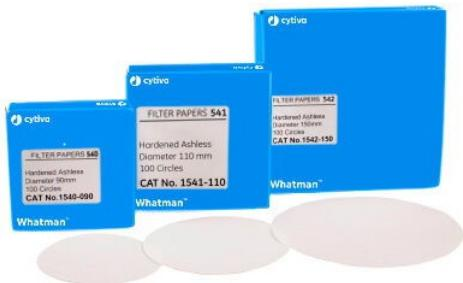
**Caratteristiche principali:** Per usi generali. Superficie molto liscia. I filtri grado 541 sono carta indurita senza ceneri (max 0,006%) che permette la filtrazione veloce di particelle grossolane e precipitati gelatinosi in soluzioni acide o basiche nell'ambito dell'analisi gravimetrica. Le applicazioni tipiche includono l'analisi della fibra nei mangimi animali, della gelatina nel latte e nella panna, dei cloruri nel cemento e dei cloruri e del fosforo in carbone e coke. .
