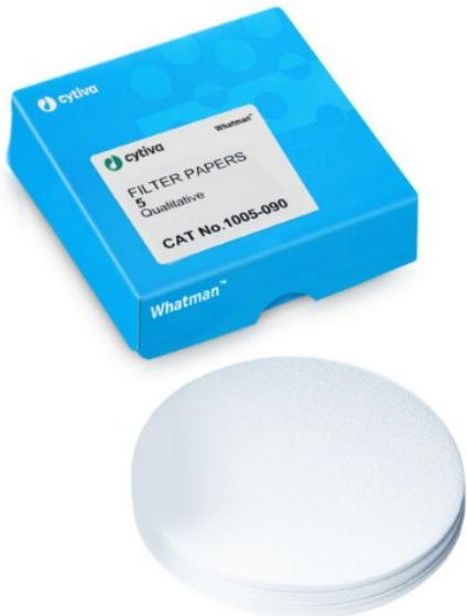
Caratteristiche principali: Usata in tecniche analitiche qualitative. Prodotta in modo da ottenere un contenuto di cellulosa minimo del 98% . Rappresenta il grado più fine di filtrazione nel range delle carte qualitative. E' in grado di trattenere i precipitati fini che si incontrano nelle analisi chimiche. Velocità di filtrazione: lenta. Eccellente per la chiarificazione di sospensioni turbide e per l'analisi di acqua e suolo. E' disponibile anche in dischi pieghettati. .
