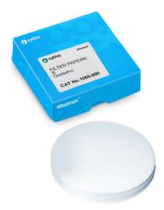
Caratteristiche principali: Usata in tecniche analitiche qualitative. Prodotta in modo da ottenere un contenuto di cellulosa minimo del 98%. Rappresenta il grado più fine di filtrazione nel range delle carte qualitative. E' in grado di trattenere i precipitati fini che si incontrano nelle analisi chimiche. Velocità di filtrazione: lenta. Eccellente per la chiarificazione di sospensioni torbide e per l'analisi di acqua e suolo. E' disponibile anche in dischi pieghettati.
