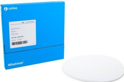
Caratteristiche principali: Progettata per le analisi gravimetriche e per la preparazione di campioni per le analisi strumentali. La carta da filtro grado 44 è ceneri (max contenuto di ceneri: 0,007%). Rappresenta la variante sottile della carta Grado 42, capace di trattenere particelle molto fini, ma con più basso contenuto di ceneri in rapporto al peso del filtro e con velocità di filtrazione quasi due volte superiore al grado 42. Sono disponibili anche misure diverse da quelle indicate. .
