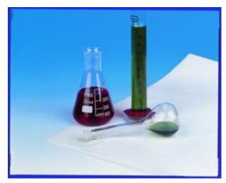
Caratteristiche principali: La parte superiore non plastificata consente di rimuovere in modo rapido i liquidi versati, la parte inferiore con uno strato di polietilene protegge la superficie sottostante. Grammatura ca. 160 gr/m2. .
