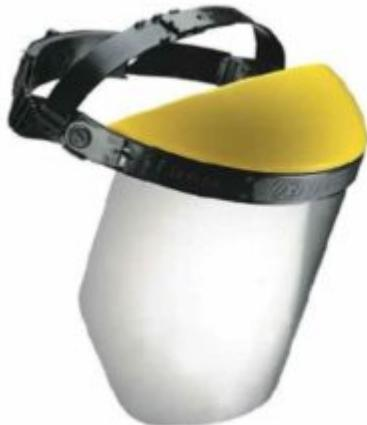
Caratteristiche: Visiera protettiva con schermo in policarbonato trasparente che permette un'efficace protezione dagli spruzzi accidentali. Schermo frontale rialzabile, caschetto fermatesta regolabile. Dimensioni 23x30 cm. Conforme alla norma UNI-EN 166. .
