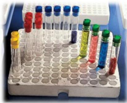
Vassoi per provetteMateriale: Polistirene espansoSono utili per alloggiare differenti tipi di contenitori e provette.
