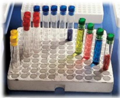
Vassoi per provette in polistirene espanso. Sono utili per alloggiare differenti tipi di tubi e provette. Possono contenere anche le microprovette tipo Eppendorf®. .
