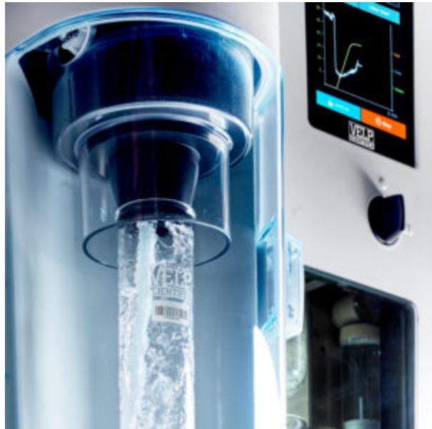
L'UDK 159 è dotato di una completa serie di funzioni per la sicurezza in laboratorio. Diversi sensori controllano il posizionamento del provettone, le porte, i livelli dei reagenti e la portata dell'acqua di raffreddamento.
