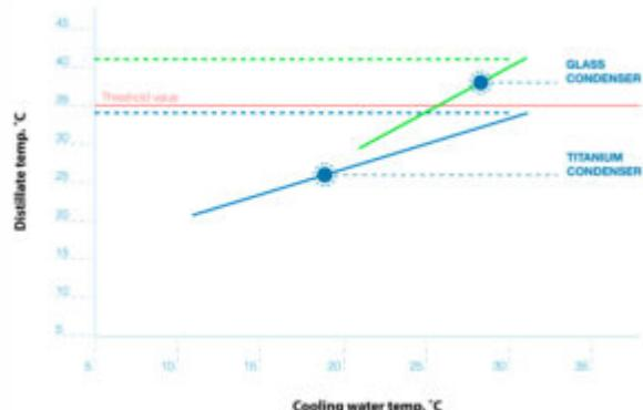
L'UDK 159 è dotato dell'esclusivo **condensatore in titanio VELP**, progettato e **brevettato** per garantire uno scambio termico efficiente e un basso consumo d'acqua.
