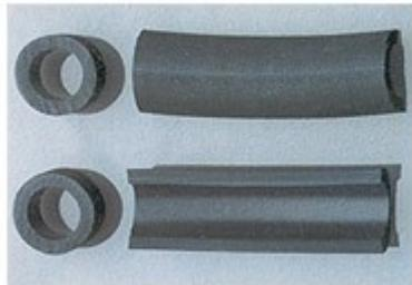
Tubo in fluoroelastomero Viton per condotta senza pressione di acidi forti, ossidanti, solventi aromatici, clorurati e alcoli. Temperatura -10+230 °C. Confezione minima 5 metri.
