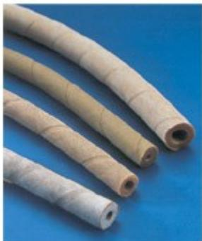
Tubo di particolare flessibilità e ottima resistenza meccanica facilmente calzabile su raccordi e portagomma in vetro. Adatta per condotta di gas e liquidi in genere. Colore beige, superficie esterna impressione tela, sterilizzabile in autoclave. Temperatura -40+80 °C. Confezione indivisibile da 6 metri.
