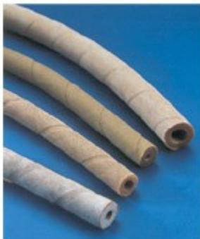
Tubi di particolare flessibilità e ottima resistenza meccanica facilmente calzabili su raccordi e portagomma in vetro. Adatti per vuoto e condotta di gas e liquidi in genere. Colore beige, superficie esterna impressione tela, sterilizzabili in autoclave. Temperatura di lavoro: -40÷+80° C.
