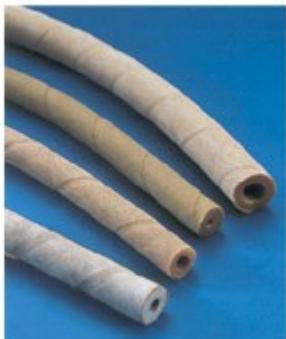
Tubo di particolare flessibilità e ottima resistenza meccanica facilmente calzabile su raccordi e portagomma in vetro. Adatta per condotta di gas e liquidi in genere. Colore beige, superficie esterna impressione tela, sterilizzabile in autoclave. Temperatura -40+80 °C. Confezione indivisibile da 6 metri.
