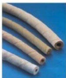
Tubo in gomma naturale in mescola speciale ottenuto da foglia avvolta e vulcanizzata su interna liscia e ben esterna ad impressione beige. Tubo di particolare flessibilità ed ottima resistenza meccanica, facilmente calzabile su raccordi e portagomme in per condotta di gas e liquidi in genere. Temperatura -40°/+80° 47+/-5 sh a (DIN 53535)Densità +/- g/cm<sup>3</sup> (ASTM D297)Carico di rottura>=190 190 kg/cm<sup>2</sup> (ASTM D412 C)Allung. a rottura >=600% (ASTM D412 C)
