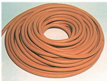
Tubo in gomma sintetica color arancio o nero per condotta senza pressioni di acidi e solventi in genere escluso benzolo e solventi affini. Superficie esterna liscia. Temperatura -35+85 °C.
