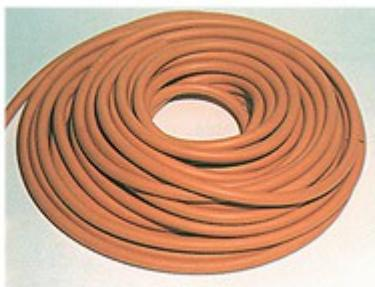
Tubi in gomma sintetica color arancio o nero per condotta senza pressioni di acidi e solventi in genere, escluso benzolo e solventi affini. Superficie esterna liscia. Temperatura di lavoro: -35÷+85° C.
