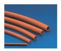
Tubo gomma arancione, superficie liscia per condotta senza pressione di gas e liquidi in genere. Sopporta temperatura fino a 60 °C.
