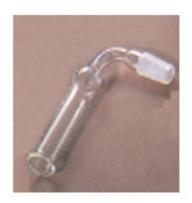
Tubi per calcio cloruro con bolla e raccordo con cono NS piegato vetro borosilicato. .
