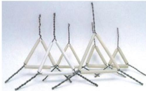
**Caratteristiche:** Costruiti con cilindretti in refrattario oppure quarzo Filo di ferro cromato Elevata resistenza chimica .
