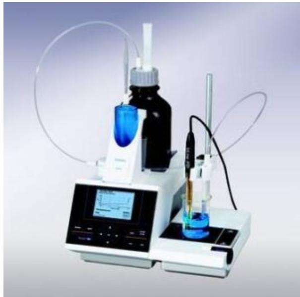
Il titolatore potenziometrico TL 7000 è uno strumento progettato per eseguire titolazioni pH-metriche, redox, argentometriche, fotometriche e titolazioni pH stat (enzimatiche).
