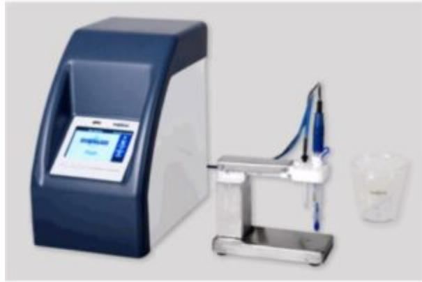
Titolatore automatico per enologia, progettato per l'analisi di pH, acidità totale e anidride solforosa (SO<sub>2</sub> libera, totale e combinata). Adatto per cantine e laboratori, è una soluzione compatta e affidabile per controlli analitici precisi.
