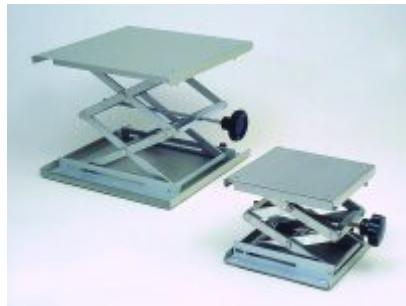
Caratteristiche: A doppio parallelogramma in acciaio inox. Con base robusta provvista di quattro piedini antisdrucchiolo. Altezza regolabile.
