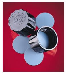
Tappi in bachelite ideali per lavori in colture Possono sopportare ripetuti cicli di sterilizzazione a vapore e calore secco ( $121\ ^{\circ}$  per 2 ore) .
