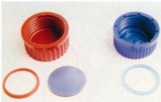
Caratteristiche: Colore rosso Autoclavabili temperatura 121 °C Temperatura massima 180 °C Adatti a bottiglie con collo ISO con guarnizione in silicone rivestita in PTFE
