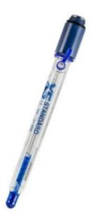
Caratteristiche: Corpo in vetro ( $\emptyset$  mm 12) e membrana cilindrica per usi generali Elettrolita KCl 3M ricaricabile Eccellente resistenza chimica e facile da pulire Con numero di serie e certificato. .
