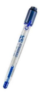
Elettrodo di pH combinato a basso errore in ambiente alcalino.Corpo in vetro e membrana cilindrica.Ideali per misure in campioni con alta temperatura e molto alcalini, tra pH 10 e 14.Elettrolita KCl 3M ricaricabile.Con numero di serie e certificato.Testa a vite S7, senza cavo.
