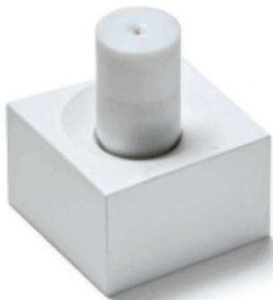
Stampo compatto per modellare la tin foil prima della pesatura del campione.
