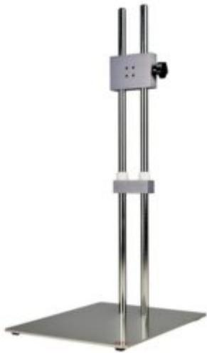
Supporto con piastra in acciaio inossidabile e due aste di supporto (altezza 700 mm), supporto per unità di azionamento regolabile in altezza e barra di posizionamento di sicurezza. .
