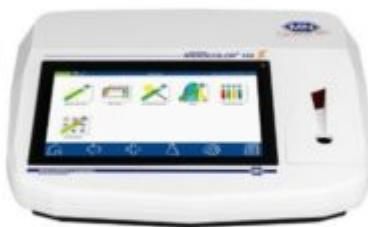
Gli Spettrofotometri Nanocolor UV/VIS II e VIS II combinano tecnologia e semplicità nell'utilizzo. Grazie al Monocromatore sono la soluzione ideale per analisi di routine di acque e acque di scarico, secondo metodiche le ufficiali.
