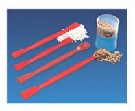
Spatole da laboratorioMateriale: Nylon caricato/fibra di vetroSpatole per usi generali, robuste e poco costose realizzate secondo le norme DIN 12890, con eccellente resistenza chimica.Configurazione: spatola più cucchiaio.Utilizzabili in campo alimentare. (NSF/ANSI STANDARD 51) .
