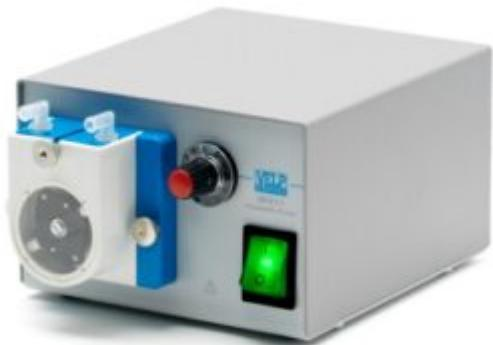
SP311 Pompe peristaltiche monocanale a portata variabile complete di tubo. Particolaramente indicate per il trasferimento di liquidi, gas, miscele, emulsioni, ecc. Struttura metallica con verniciatura epossidica altamente resistente ai reagenti chimici, meccanici e corrosivi in genere. Controllo elettronico del numero dei giri. Motore 24V CC con riduttore. Facile sostituzione del tubo. .
