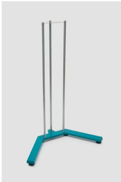
**Caratteristiche:** Le aste sono collegate tra loro in modo di ottenere la massima robustezza e rigidità. Base in ghisa verniciata Apertura della base Lunghezza 660mm x profondità 230 mm. Fornito completo di tre aste in acciaio inox 18/8 (ØxL mm) 15x 1000 .
