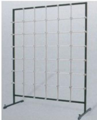
Caratteristiche: Struttura portante in tubolare di alluminio 40×20 mm verniciato a fuoco con vernice epossidica anti corrosiva. Le aste all'interno della struttura sono in alluminio e con diametro di 12 mm morsetti in alluminio Base di appoggio provvista di piedini regolabili. .
