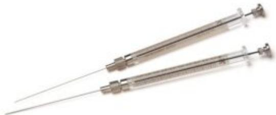
Microsiringhe Hamilton serie 7000 per iniezioni rapide di piccoli volumi, di elevato standard qualitativo e tecnologico, sottoposte a severi controlli di qualità ad ogni passaggio di fabbricazione. Vengono prodotte in svariate serie, per essere utilizzate in qualsiasi genere di applicazione. Accuratezza  $\pm 2\%$ , riproducibilità  $\pm 1\%$ . In questo modello la sigla N non identifica un ago cementato bensì un ago rimovibile con anello zigrinato.
