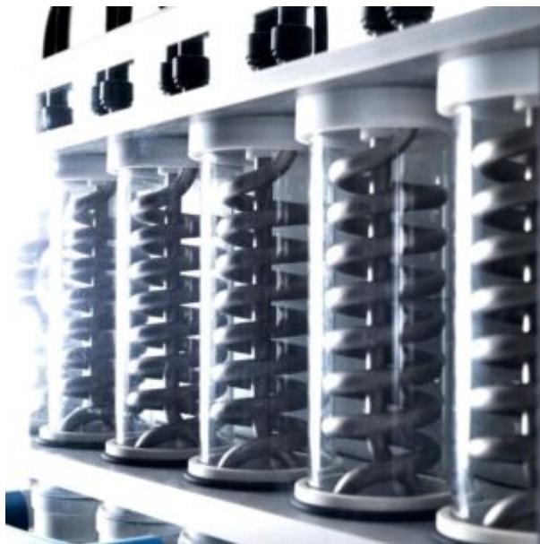
I **condensatori in titanio** VELP garantiscono **un recupero di solvente superiore al 90%**. Il solvente recuperato viene immagazzinato nel serbatoio raffreddato posto sul retro dello strumento.
