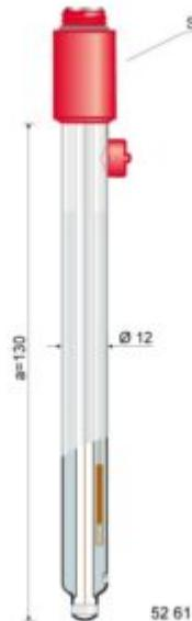
Caratteristiche: Elettrodo in platino per ORP/RedOx con elettrolita liquido riferimento Ag/AgCl incapsulato diaframma in ceramica corpo in vetro tappo a vite S7. Range  $\pm 2000$  mV, 0 – 80 °C. Alta stabilità e lunga durata .
