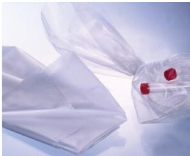
Sacchetti per sterilizzazione originali Greiner Bio One: Temperatura massima 134°C, 30 min (in autoclave). Temperatura massima 160°C, 2 h (in sterilizzatori a secco). Ideali per l'eliminazione igienica dei prodotti di laboratorio contaminati. Realizzati in poliammide per la sterilizzazione in autoclave a vapore. Spessore del foglio: 0,05 millimetri. .
