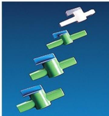
Rubinetti d'intercettazione, in polipropilene (PP) e polietilene ad alta densità (HDPE). Ideali per liquidi e gas a bassa pressione (pressione di esercizio 0,5 bar) o leggero vuoto. Il corpo in HDPE e la chiave in PP permettono una rotazione sensibile senza bisogno di lubrificanti. Tutti i rubinetti hanno i fori di passaggio rettilinei.
