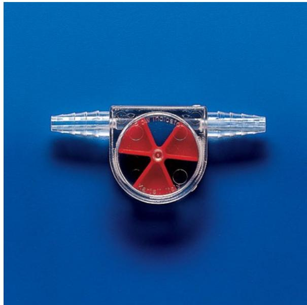
Rilevatori di flusso a turbina, in copolimero SAN. Per flussi di liquido fino a 5 ml/s. La girante gira liberamente e la velocità di rotazione è proporzionale alla portata. Portata massima consigliata fino a 95 ml/s, 2 bar di pressione massima. Da evitare l'uso con liquidi corrosivi o a temperature oltre gli 85° C. Può essere usato anche con i gas. .
