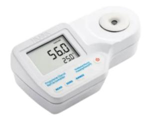
HI96832 è un rifrattometro digitale portatile e robusto, progettato per misurazioni della percentuale in volume e del punto di congelamento di soluzioni a base di glicole propilenico. HI96832 ha un'accuratezza di  $\pm 0.2\%$  volume e  $\pm 0.5$  °C punto di congelamento ed è semplice da utilizzare. Tutte le misure sono compensate automaticamente per le variazioni della temperatura e visualizzate in pochi secondi. Il prisma in vetro e la cella di misura in acciaio inox sono facili da pulire.
