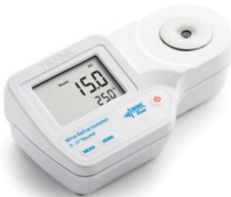
Il rifrattometro digitale **HI96813** è uno strumento professionale e portatile, progettato per produttori di vino che desiderano misurare con precisione il contenuto zuccherino (% Brix) e stimare l'alcool potenziale in uva, mosto e vino.
