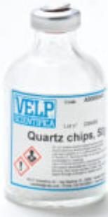
Riempimenti in quarzo da aggiungere nel reattore di pirolisi insieme alla lana di nichel e alla lana di nichel e carbone per la riduzione del campione nei suoi composti elementari.
