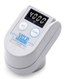
Il RESPIROMETRIC Sensor System per la biodegradabilità della plastica è progettato per supportare il test di
