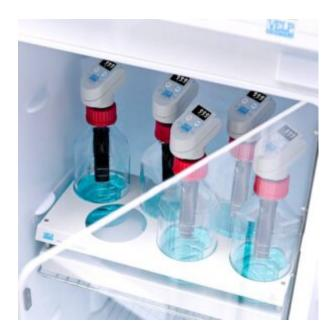
Il RESPIROMETRIC Sensor System Maxi è progettato per supportare gli studi di respirazione anaerobica atti a determinare il potenziale metanogeno BMP delle biomasse.
