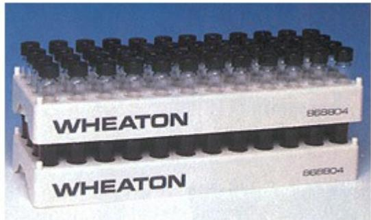
Rack per Vial in polipropilene chimicamente resistente. Possono essere usati direttamente negli shaker o nei bagnomaria, impilabili, autoclavabili a 121 °C per 20 minuti, con griglia alfanumerica per una facile identificazione dei campioni.
