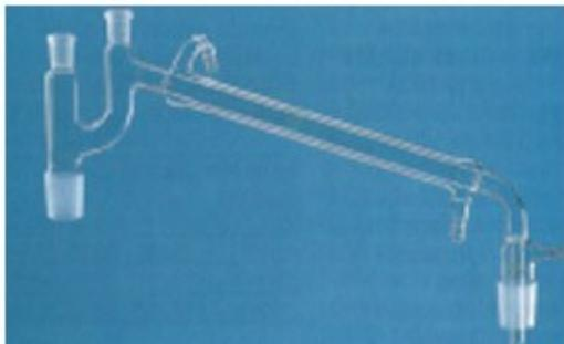
Raccordi in vetro per distillazione secondo Claisen con refrigerante inclinato di Liebig e presa per vuoto (canna saldata): Coni femmina superiori e coni maschio, laterale curvato. .
