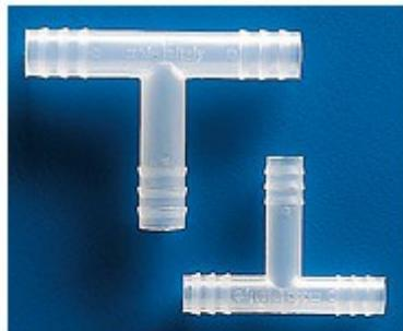
Raccordi per tubi a TMateriale: PolipropileneSterilizzabili in autoclave. Estremità dentate per una perfetta tenuta. Ottima resistenza chimica.Conformi alle norme per l'uso con sostanze alimentari. EEC 90/128 92/93 e FDA 21 CFR 177.1520.Le dimensioni riportate sono sia nominali che esatte poiché l'elasticità dei tubi influenza la scelta del tipo di raccordo adatto.
